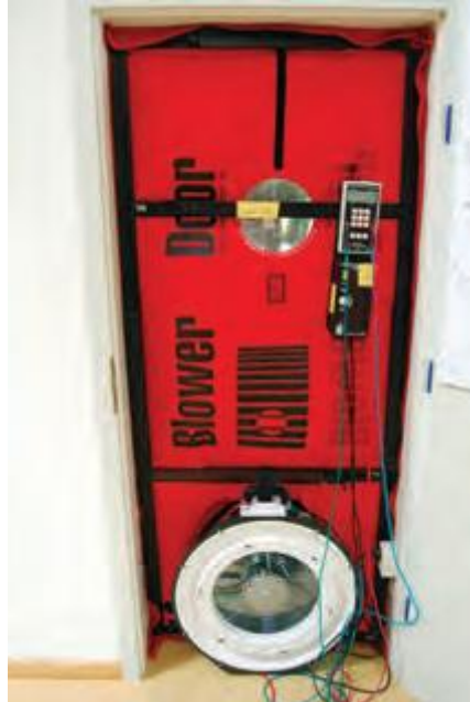
Slika 4. Oprema za provedbu ispitivanja zrakonepropunosti toplinske ovojnice | Slika: W. Walter
