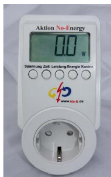
Slika 2. Primjer uređaja za mjerenje električne energije preciznosti mjerenja od 1 vat, po cijeni od 30 EUR. Izvor: www.no-e.de
