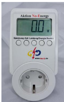
Slika 10: Primer naprave za merjenje električne energije z merilno natančnostjo 1 W, ki stane 30 EUR. Vir: www.no-e.de .
